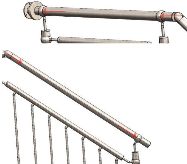
K. Nun verbinden Sie die beiden Handlaufteile über das Gelenk mit der M8 Schraube.
