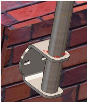
14. Bitte noch den Wandflansch oben mit geeigneten Schrauben, Dübeln und Werkzeug befestigen, damit dieser auch kein Spiel mehr hat.
