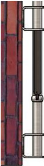
3. Richten Sie das Geländer mit einer Wasserswaage aus. Der Wandflansch sollte an der Wand anliegen. Die Steigung des Geländers sollte möglichst die Steigung der Treppe haben. Der Handlauf gerade oben sollte Waagrecht stehen, die Pfosten senkrecht. Die Füllstäbe sollte auch senkrecht sein.
